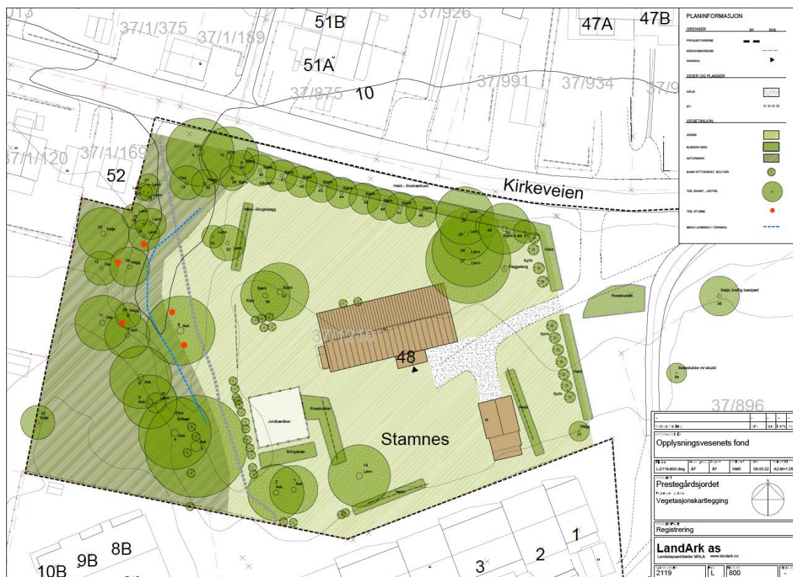
Figur 4.8.1: Kartlegging av eksisterende vegetasjon på prestegårdstomt. (LandArk AS)
